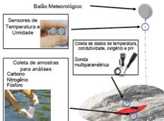
Figura 4 – Coleta de dados a partir de sensores de temperatura e umidade relativa do ar suspensos por um balão preso ao caiaque e medidas para análises de qualidade da água baseado em medidas a partir de uma sonda limnológica multiparámetro e coletas in situ . Fonte: Assireu et al. (2015).
