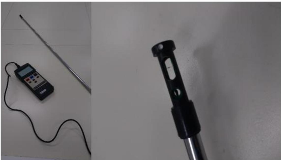
**Figura 3.9** - Anemômetro de fio quente. Fonte: DO AUTOR, 2017.
