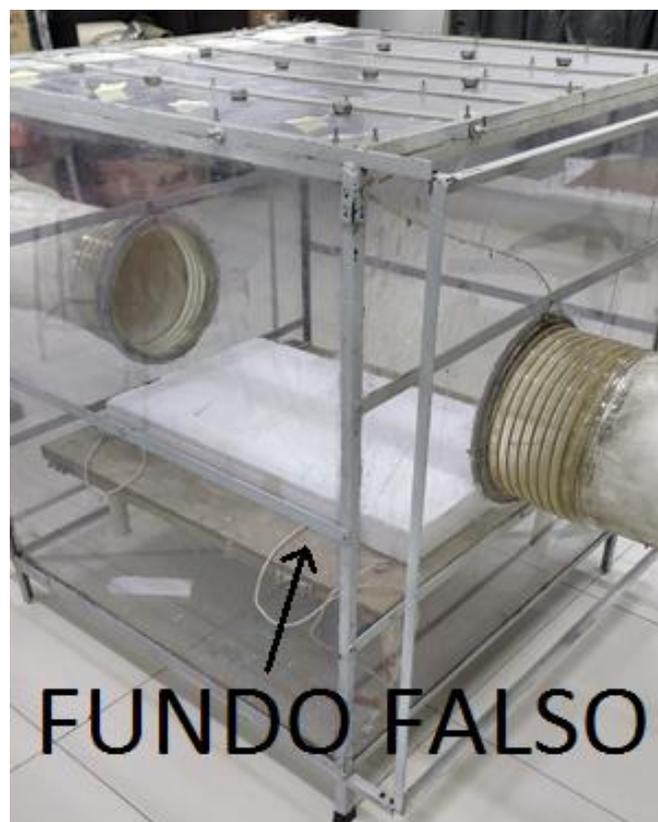
**Figura 3.13** - Câmara com o fundo falso. Fonte: DO AUTOR, 2017.
