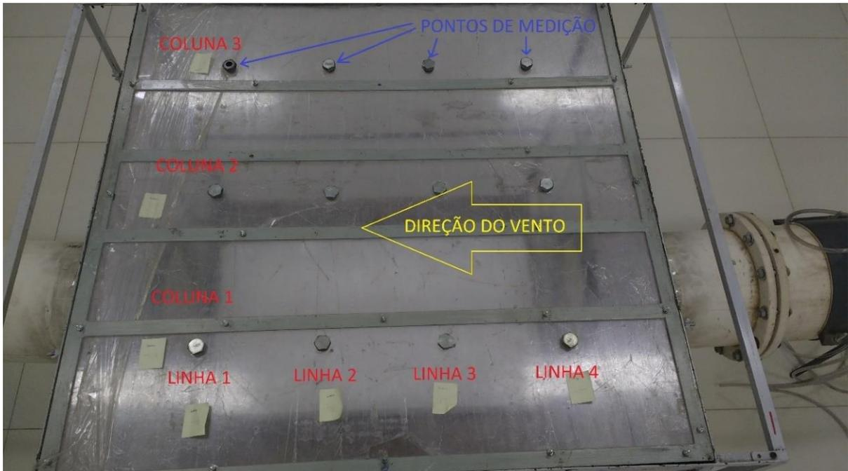
**Figura 3.10** - Câmara vazia indicando os pontos de medição. Fonte: DO AUTOR, 2017.
