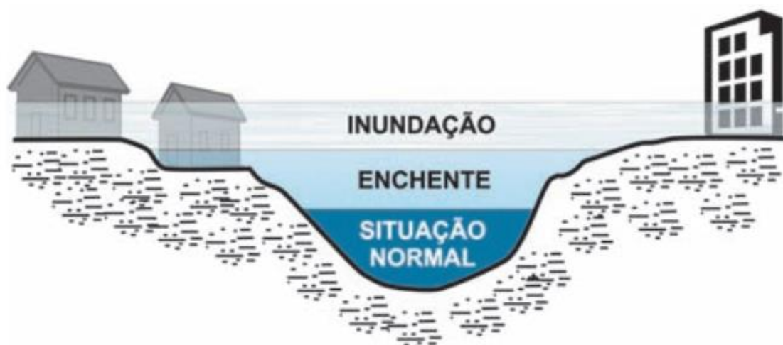
Figura 3 - Perfil esquemático do processo situação normal, enchente e inundação. Fonte: Tominaga et al. (2009).
